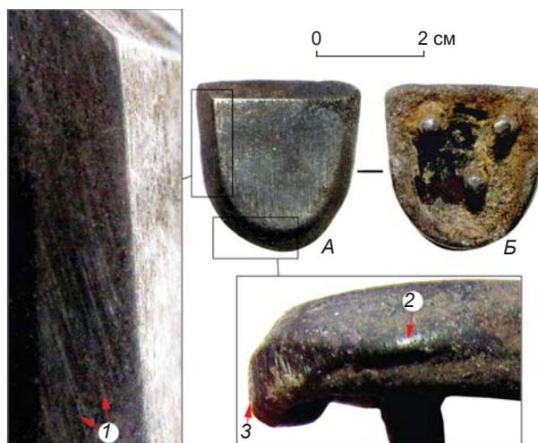
Рис. 9. Бронзовый наконечник ремня со щитком овальной формы № 1853 с лицевой (А) и оборотной (Б) сторонами. 1 – следы абразивной обработки поверхности изделия; 2 – фрагмент литейного шва; 3 – следы абразивной опиловки литейного шва.
